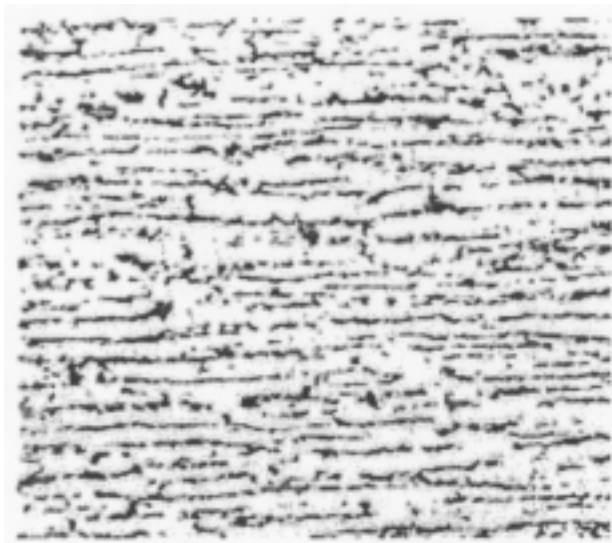
图 A1.10 双相显微组织，带状分布的等轴晶铁素体（未被侵蚀）基质上的有取向、部分拉长、显著带状分布的珠光体（深色）
